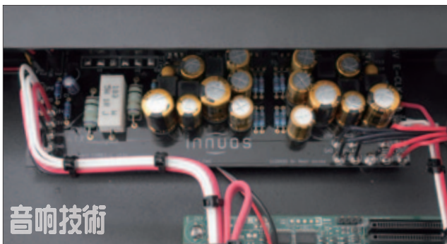
△ 過濾電容連接了線性供電，即是在輸送到模組前已作了緩衝和過濾，確保是潔淨電源，以免影響模組的運作表現。
