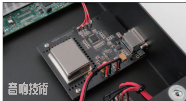
△ 從圖片可清楚看見，晶振時鐘是密封了，線路板上圍繞時鐘是 3 掛小孔，作用是疏氣以令晶振不會過熱。Innuos 採用溫度補償型，使用密閉式會形成烤爐效果，令晶振處於合適溫度，說出來，讀者或半信半疑，這份模組安裝位置是經過考慮，遠離了機箱前排疏氣位置，目的是為免氣流使晶振過份降冷。
