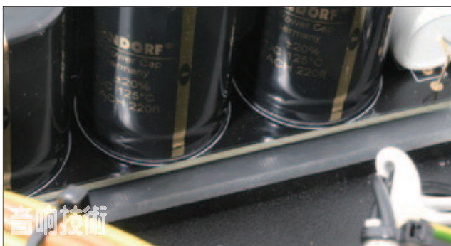
△魔鬼細節出現了！在電容底下竟是貼了非常薄的抑震物，為了好效果真是無孔不入！
