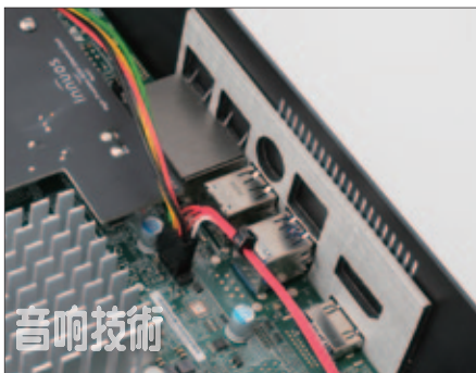
△ Innuos 為了抑制諧振，在各模組的關鍵位置或元件上，貼了吸震物，圖中看到薄薄一層灰色東西就是了，至於有沒有防磁功能就未可知了！
