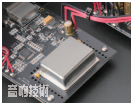
△ Innuos 為了抑制諧振，在各模組的關鍵位置或元件上，貼了吸震物，圖中看到薄薄一層灰色東西就是了，至於有沒有防磁功能就未可知了！
