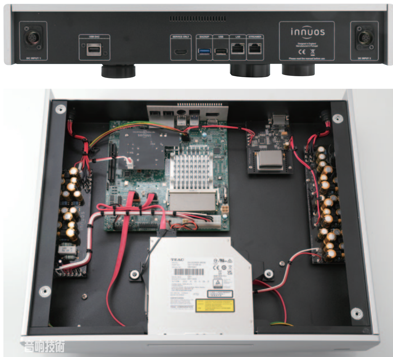
△這是 Statement 播放主機，可看見各模組線路板是刻意做出隔離效果，左右兩側是過濾電容，要留意是 Re-Clock 的 USB 端子與晶振時鐘同在一塊線路板，這也是優化設計，以最短連接減少誤差，同時避免受其他模組干擾。
