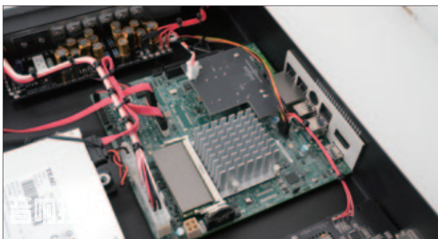
△ 機箱裡最大面積的線路板就是網絡模組，散熱片底下是 CPU，而兩組 RJ45 連接埠也是經過 Re-Clock 重整訊號時脈，晶振模組是反轉了架在模組上層，這也是最短距離，可以說能夠優化的措施都做齊了。
